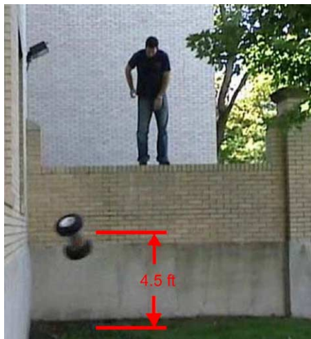
Fig. 18. Rebound height: 1.4 m.
